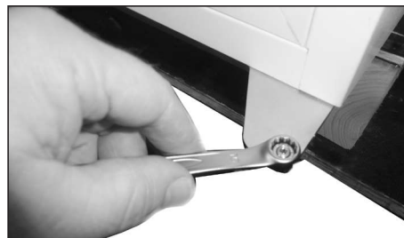
24. Mutter des Drehzapfens wieder anbringen und festziehen.
