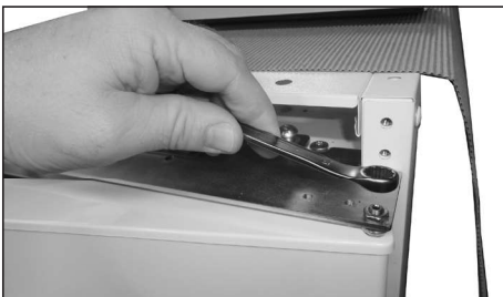
9. Mutter des Drehzapfens lösen (mit 10 mm Schraubenschlüssel)
