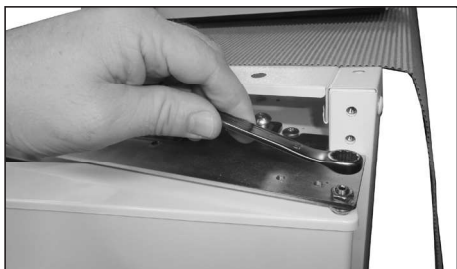
9. Loosen pivot nut (use 10 mm spanner)
