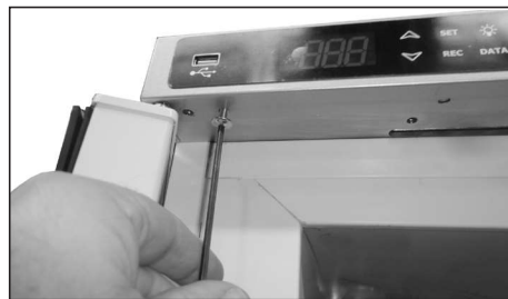
42. ... und daran denken, dass die Schraube neben dem oberen Türzapfen in der Bohrung Nr. 2 nach innen gedreht wird, um bei der Montage für ausreichend Platz zwischen Schraube und Türendkappe zu sorgen.
